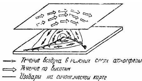
Рис. 54 Синоптическая обстановка, при которой направление и скорость ветра по высотам наиболее благоприятны для образования волновых движений
